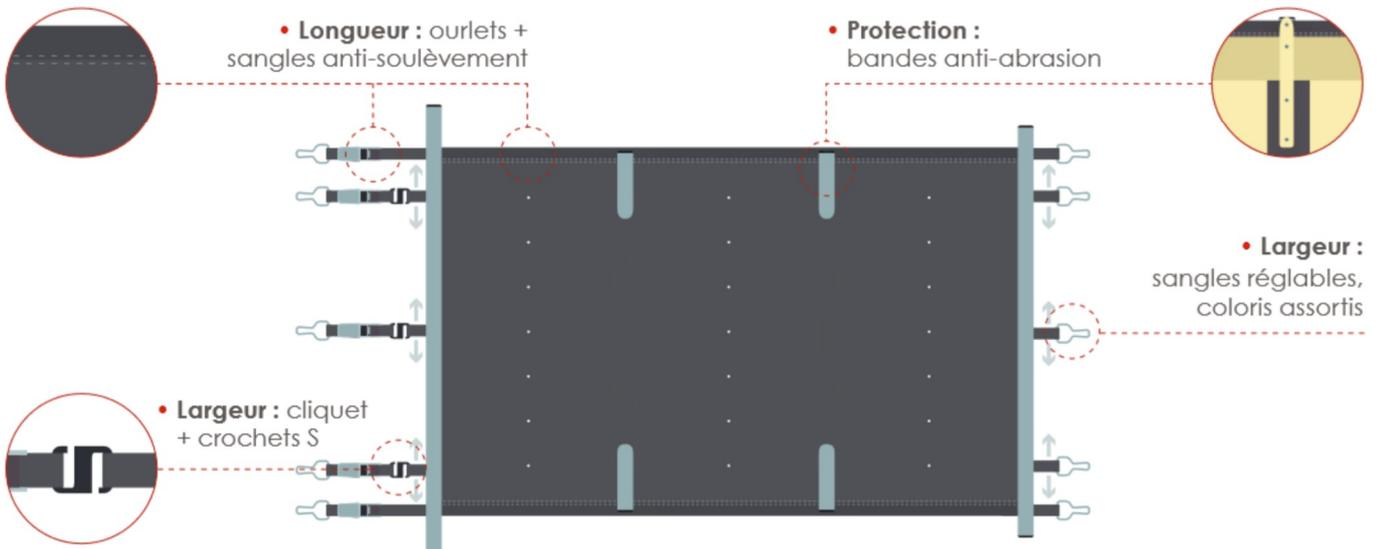
Les couvertures à barres Securit Pool Access sont conçues à partir de tissu enduit PVC 580 g/m<sup>2</sup> et composées d'un système de maintien au moyen de barres en aluminium anodisé. Elles sont dotées de cavités pour l'évacuation des eaux pluviales et sont livrées avec une manivelle manuelle démultipliée haut rendement.
