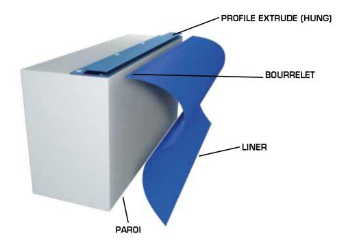
Il existe également des récepteurs qui se placent à la verticale, en sommet de paroi, sous la margelle, par exemple, dans le cas d'une margelle déjà installée que l'on ne veut pas desceller.
